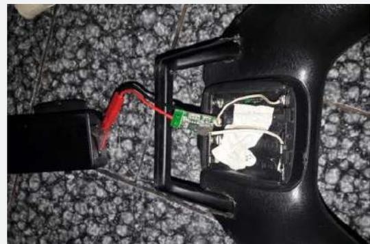
Gambar Pemasangan module step down ke remote kontrol
