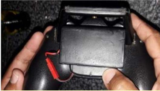
Gambar Posisi box baterai pada remote kontrol
