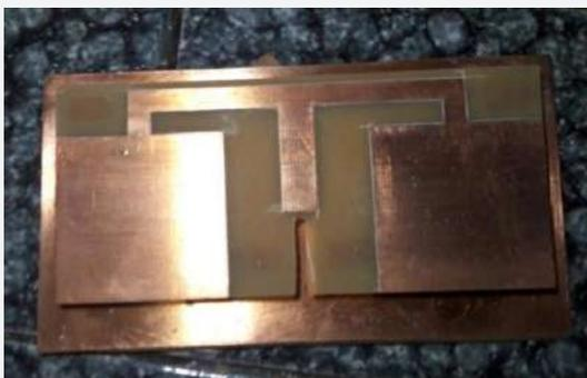
Gambar Pengeleman antara reflektor outer dan inner
