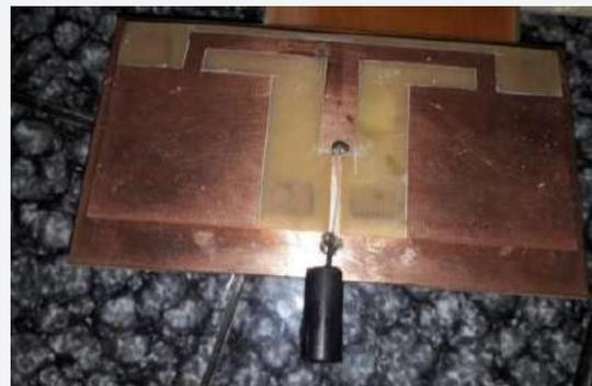
Gambar Pemasangan kabel Outer dan Inner
